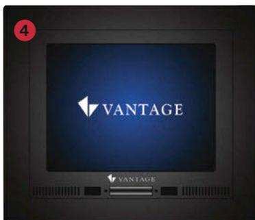
equipaggiato con un processore Intel X-Scale e lavora su sistema operativo Linux; attraverso il Vantage Ethernet Bus può essere connesso al controller InFusion. Il TPT650 può visualizzare diversi tipi di segnali compositi (provenienti da televisori o videocamere) ed è dotato di slot per scheda SD, di quattro ingressi video e audio stereo e di un sensore luce che regola automaticamente l'intensità del touch screen in funzione della luminosità ambientale.
